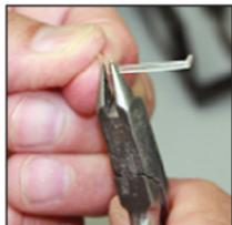
Créez la rétention en formant une boucle sur le côté opposé du crochet pour le fixer dans la résine.
