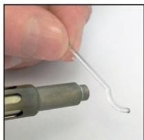
Chauffez le crochet avec un chalumeau à air chaud, en l'agitant légèrement. Puis passez légèrement une pince au-dessus de la source de chaleur. (ATTENTION : ne surchauffez pas le crochet, ni la pince)
